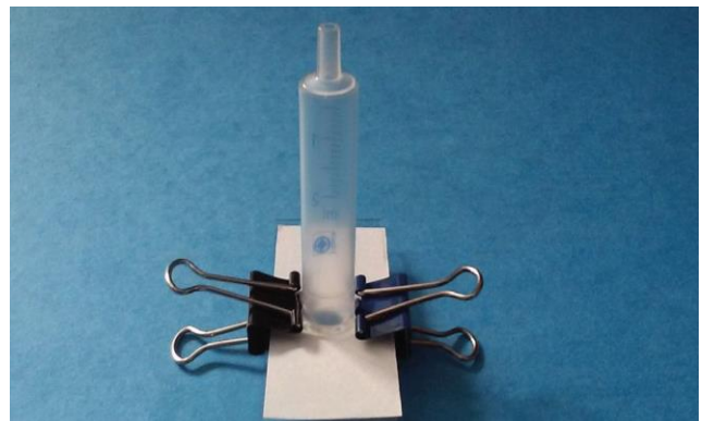
Obr. 2: Sedimentačná komôrka, vyrobená z podložného sklíčka, filtračného papiera s vystrihnutou dierou, striekačky a dvoch silných štipcov
